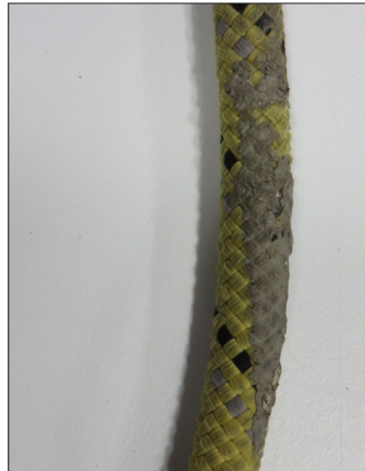
• Rastro de producto químico
