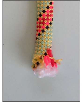
• Estremità di fune danneggiata
