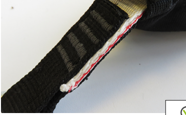
• Das Gurtband des Falldämpfers ist intakt
