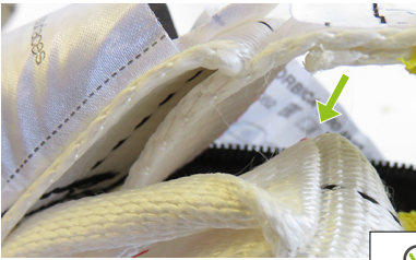
• Falldämpfer nicht aufgerissen
