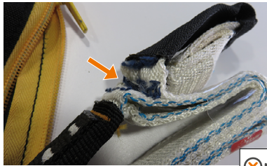
• Der Falldämpfer wurde einem Fangstoß ausgesetzt, er ist teilweise aufgerissen
