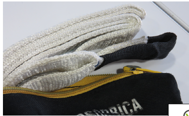
• Das Gurtband des Falldämpfers ist intakt
