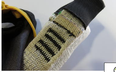
• Der Falldämpfer wurde einem Fangstoß ausgesetzt, er ist teilweise aufgerissen
