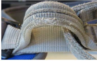
• Punto de encordamiento desgastado
