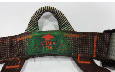
• Rastros de pintura
