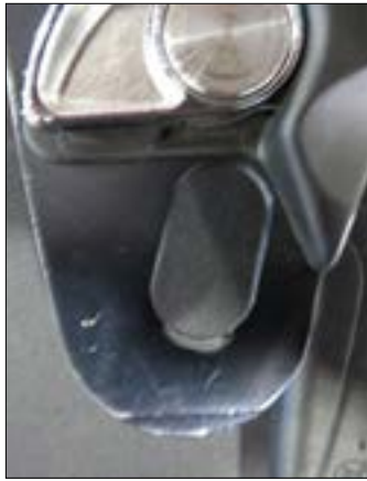
• Foro di collegamento deformato in seguito a urto
