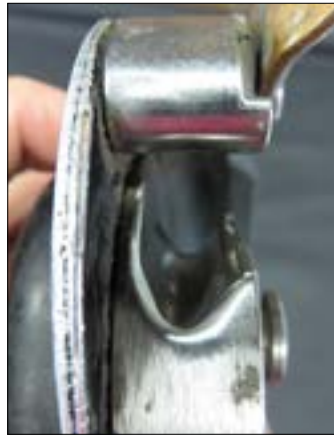
• Indicatore di usura danneggiato
