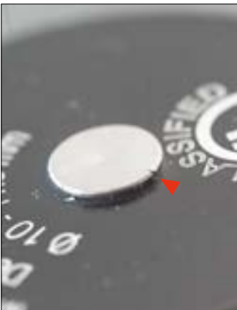
• Rivetto con leggere fessurazioni
