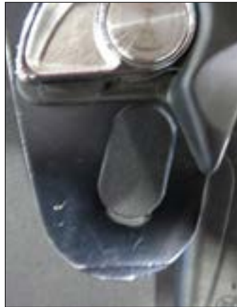
• Verbindungsöse wurde durch einen Schlag verformt
