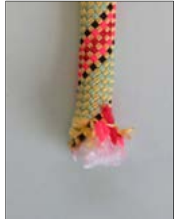
• Estremità di corda danneggiata
