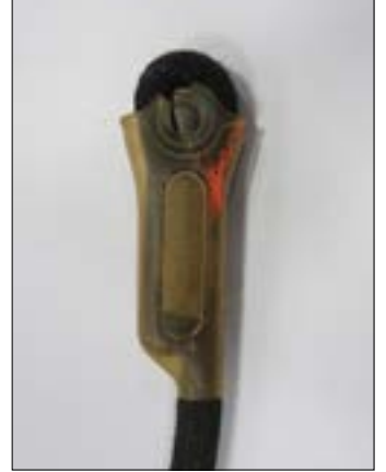
• Funda plástica deteriorada
