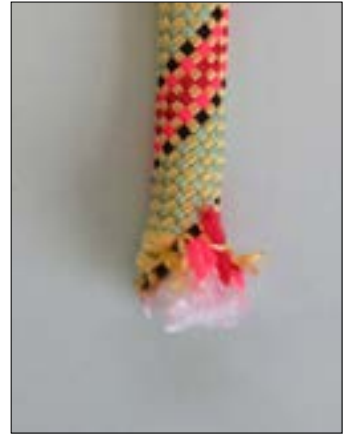
• Puna de cuerda dañada
