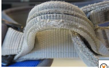
• Testigo de desgaste visible
