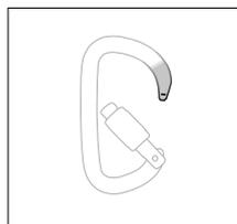
• Verificare lo stato del becco (segni, usure, fessurazioni, deformazioni...).
