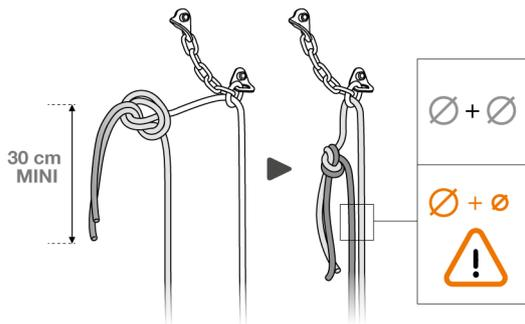
Releasable system / Système débrayable
