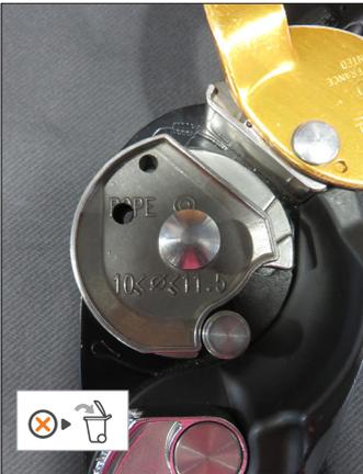
• Verbindungsöse wurde durch einen Schlag verformt
