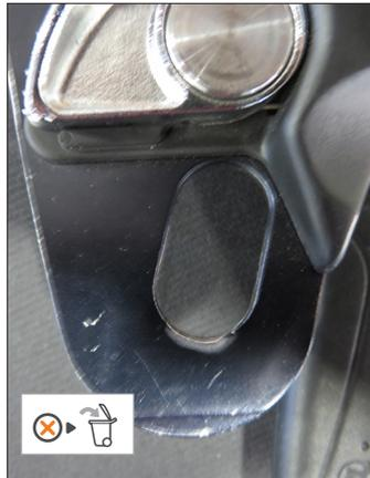
• Verschleißanzeige abgeschliffen
