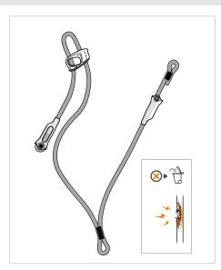
Untersuchen Sie den Mantel auf durch Benutzung hervorgerufene Abnutzungserscheinungen und Beschädigungen (Einschnitte, aufgeraute Stellen, Spuren von chemischen Produkten usw.).
