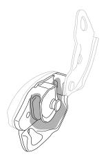
• Compruebe la ausencia de cuerpos • Compruebe el estado de los extraños (arena...) y de lubricante en el paso de la cuerda.
