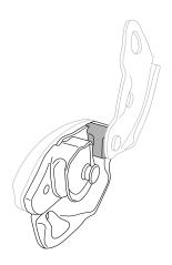
• Compruebe el estado del patín (marcas, deformaciones, suciedad, fisuras...).
