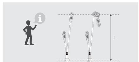
\*Die Länge des Verbindungsmittels wird am nicht belasteten Verbindungsmittel und von der Verbindungsmitte an jedem Ende (vernähte Endverbindung, Ankerstich oder ADJUST-Einstellvorrichtung) gemessen.
