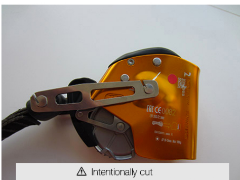
El prototipo ASAP LOCK después del ensayo dinámico
