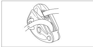
• Vérifiez l'état de la poignée (marques, déformations, fissures...). Vérifiez le bon fonctionnement du ressort de rappel de la poignée.
