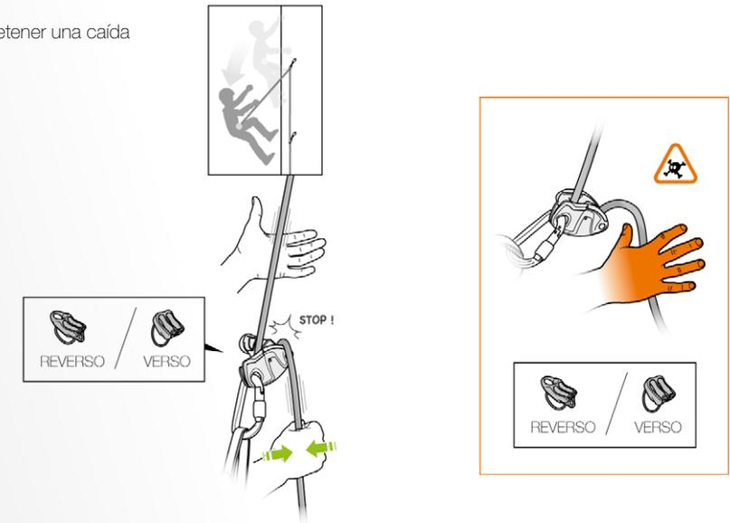
Para un aseguramiento dinámico: dé un salto o un paso hacia delante para amortiguar la caída del escalador.
